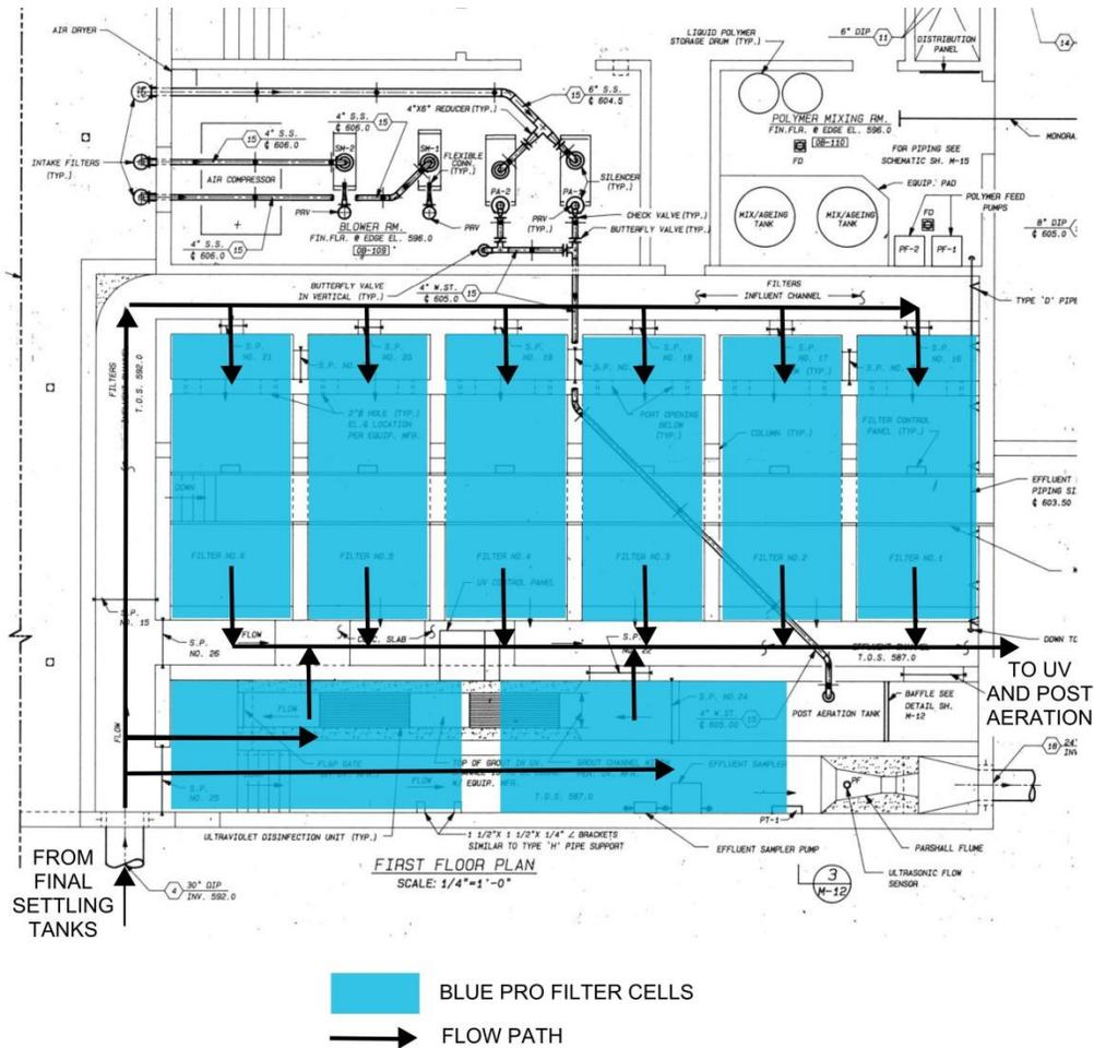
**FIGURE 7-14. BLUE PRO ALTERNATIVE PROCESS LAYOUT**
