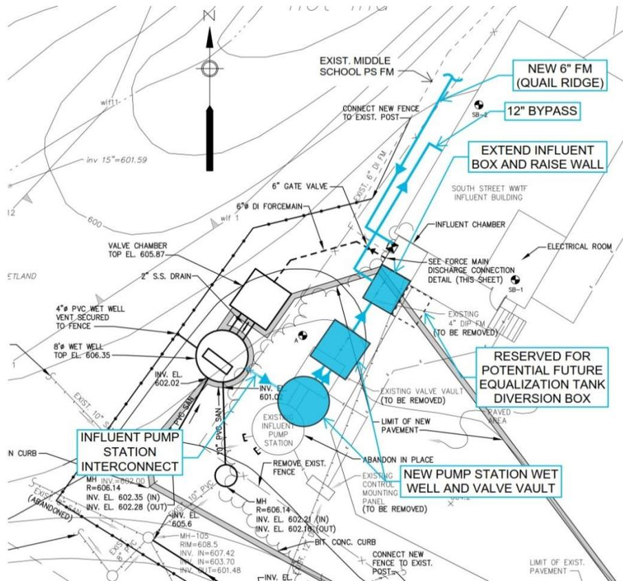
**FIGURE 9-2. RECOMMENDED INFLUENT PUMP STATION AND INFLUENT BUILDING BOX LAYOUT**
