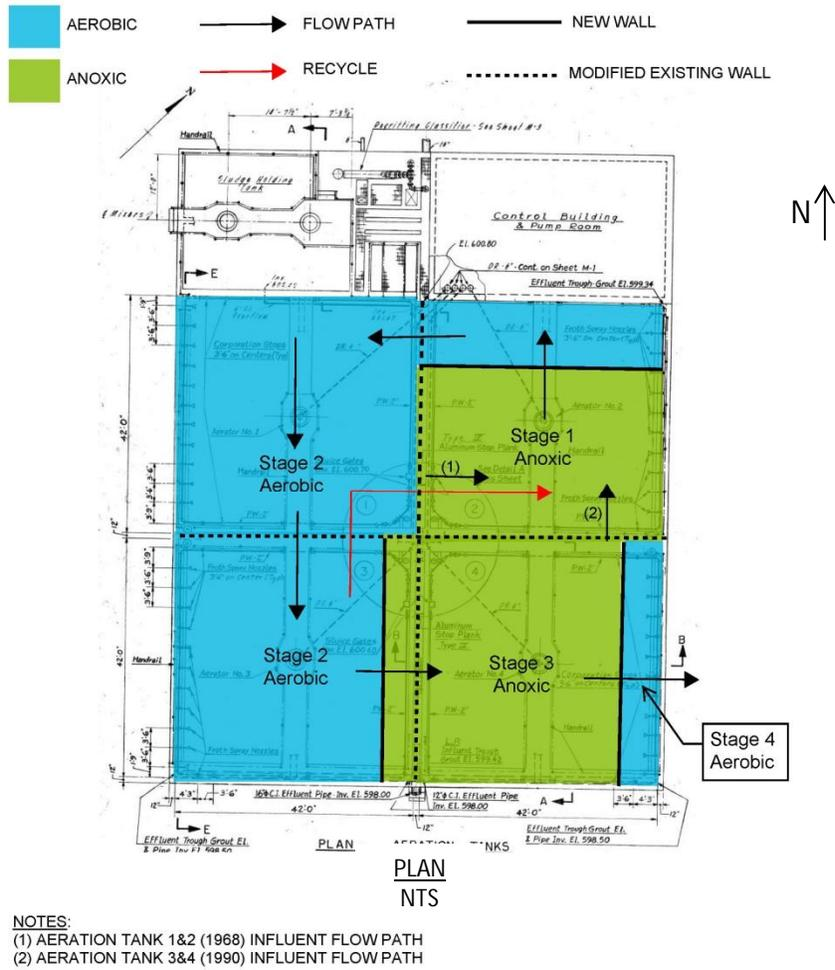
FIGURE 7-6. SOUTH STREET WWTF AERATION TANK 4-STAGE BARDENPHO PROCESS CONFIGURATION
